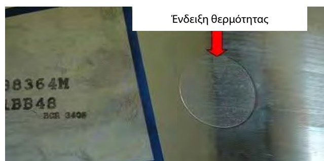
Εικόνα 13-5 - Ένδειξη θερμότητας (έκδοση 2) στο κοίλωμα της ζάντας, κοντά στον σειριακό αριθμό και στην οπή της ζάντας
