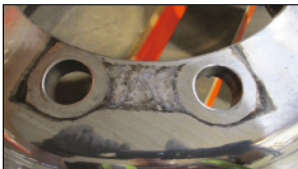
Γαλβανική διάβρωση στις πλευρές επαφής της ζάντας προστασίας των παξιμαδιών ή των καλυμμάτων των παξιμαδιών.
